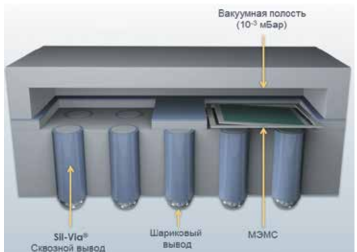
7 Поперечное сечение устройства, изготовленного по технологии Si-Via с использованием гидрофобной и гидрофильной сварки кремниевых пластин [15]
