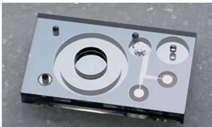
3 Микрофлюидное устройство, изготовленное с помощью анодной сварки стекла и кремния
